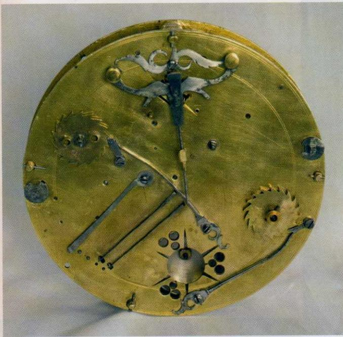
Máquina desmontada vista por su parte posterior. Se observa el foliot y la celosía para la salida del sonido de las campanas.
